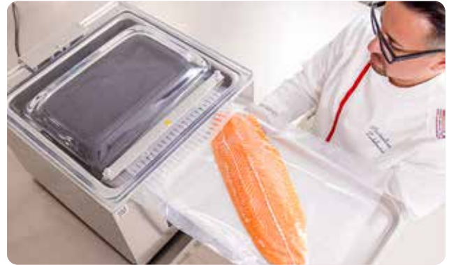
Verwendung von geprägten Vakuumbiegeln für externes Vakuumieren.
