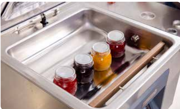
Vakuumieren von Konservengläsern in der Druckkammer
